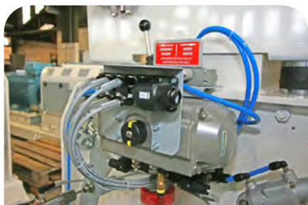
Répartiteur de raccordement rapide à la supervision
