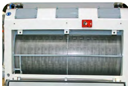
Chambre de broyage intégralement occupée par les grilles
