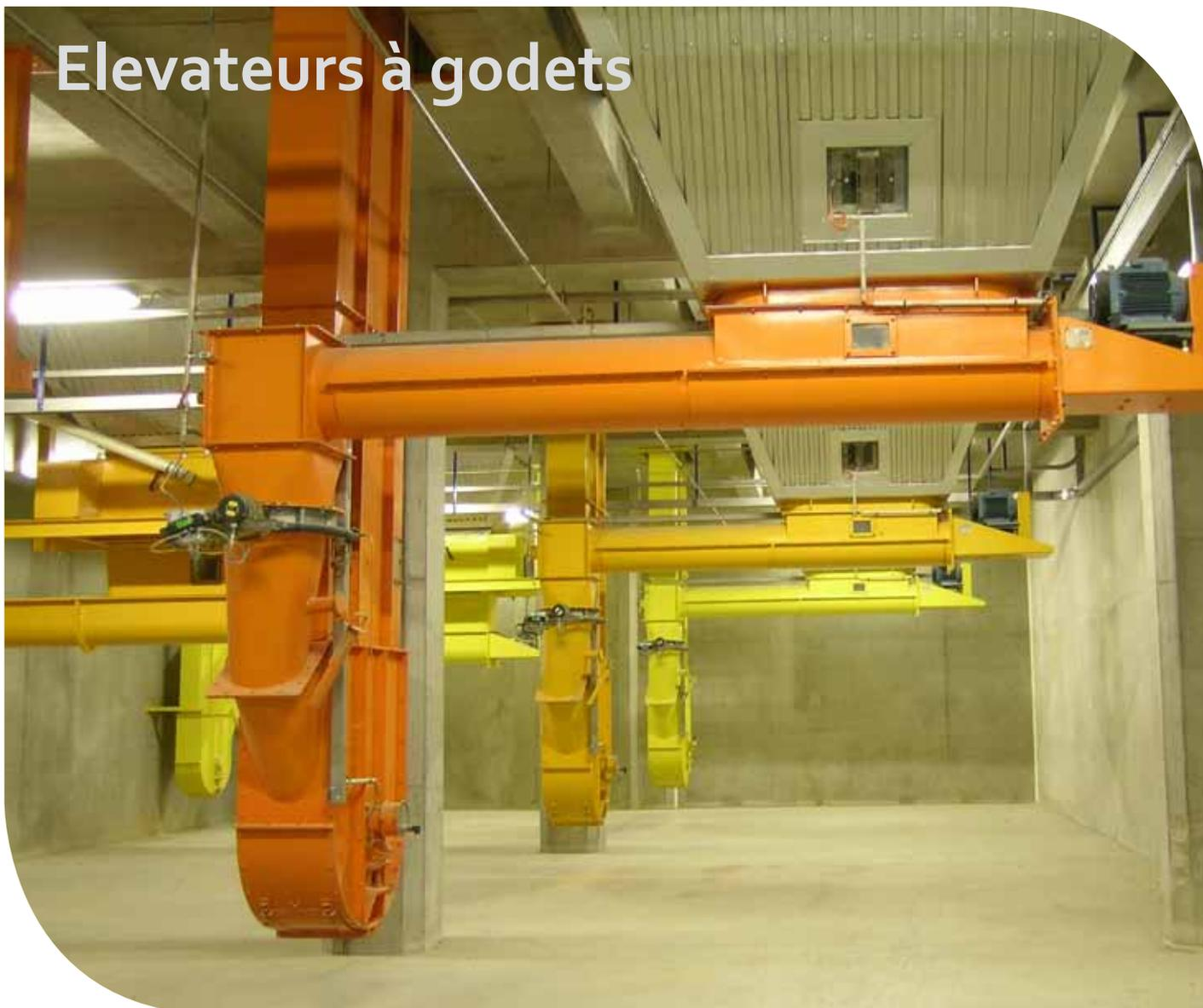
Un élévateur à godets est un appareil permettant la manutention de produits granuleux et pulvérulents sur une trajectoire linéaire verticale.
