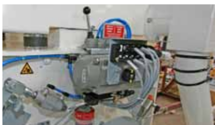
Actionneur rotatif pour orientation du volet d'alimentation
