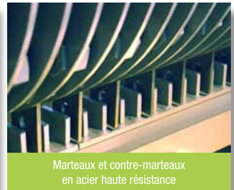
Chambre de broyage intégralement occupée par les grilles
